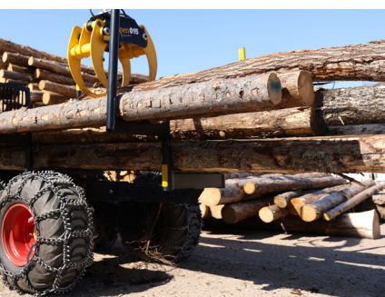
HSP grip 015 og LogMax LM2000T er standardutstyr på maskinen.
