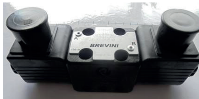
Bilden visar den äldre ventilen 10001141 för kvistknivar och nedre kvistkniv, märkt "BREVINI" som bör bytas.
